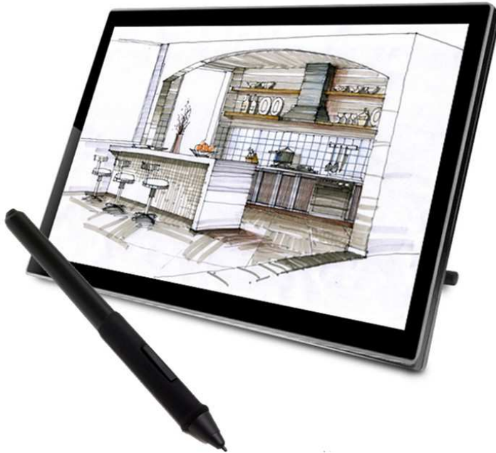
Display: 22" Full-HD (1920 x 1080 Pixel) Stylus: Druck- und Neigungssensor, batterieles
